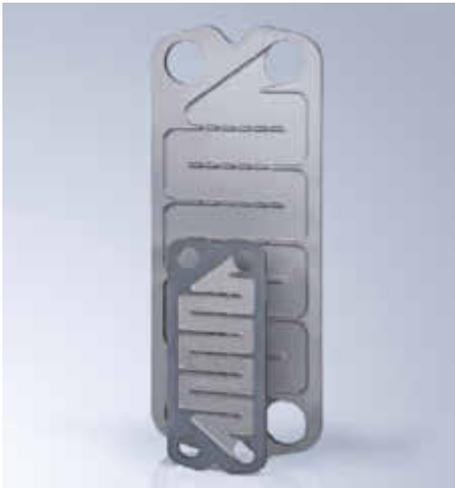
Eine mäanderförmige Kanalstruktur sorgt für eine sehr gute Flächenausnutzung bei weitgehend fehlenden Kurzschluss- und Totraumanteilen
